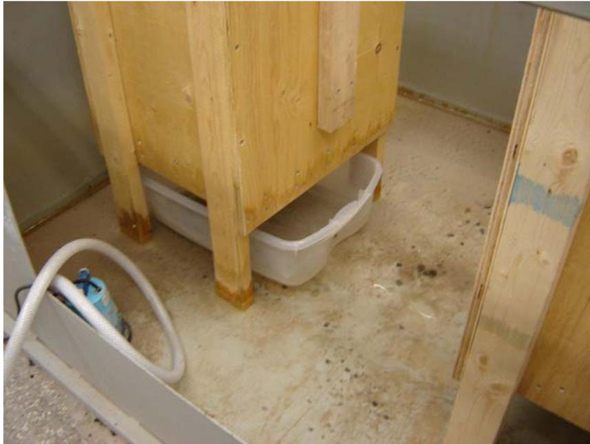
**Figure 3-9: Effluent Collection Tray**
